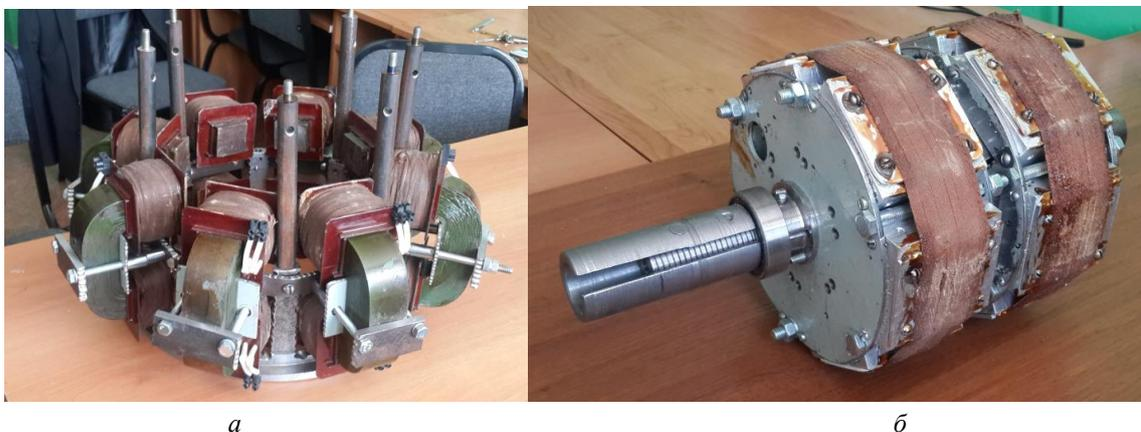
Рис. 2. Макетный образец СГПМ модульного типа:
