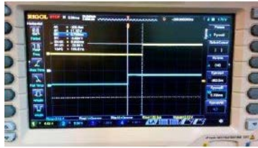
Рис. 3. Пример осциллограммы, полученной при измерении скорости потока ионов
