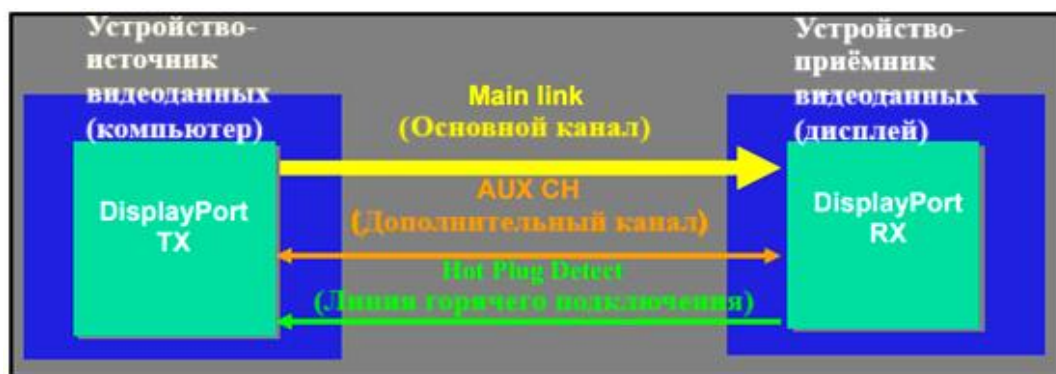
Рис. 1. Каналы интерфейса DisplayPort
