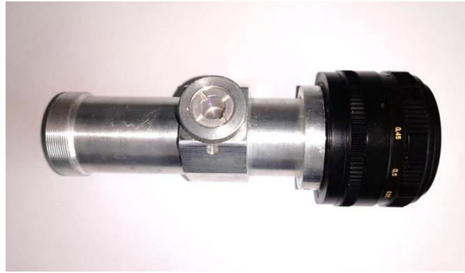
Рис. 5. Оптическая система опытного пирометра спектрального отношения
