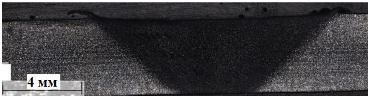
Рис. 6. Поперечное сечение сварного соединения пластин из стали ст3
