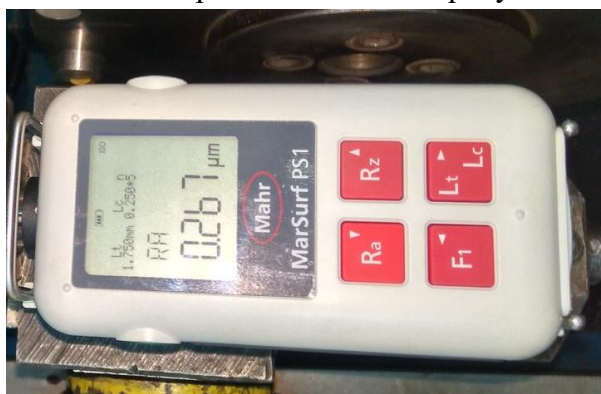
Рис. 2. Замер шероховатости полученной поверхности профилометром MarSurf PS1
