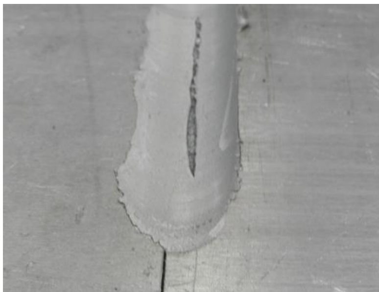
Рис. 1. Дефект типа «непровар»
