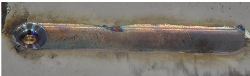
Рис. 5. Сварной шов пластин из нержавеющей стали 12X18H10Т толщиной 2 мм
