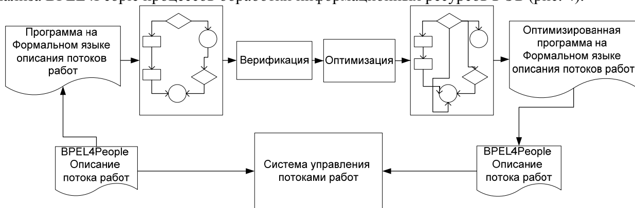
Рис. 4. Схема автоматической верификации и оптимизации BPEL4People процесса
