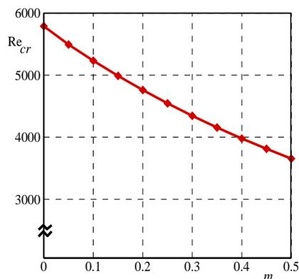
Рис. 2. Зависимости критического числа Рейнольдса от параметра  $m$  для термовязкого профиля скорости при фиксированном значении параметра  $\alpha_E = 0.5$ .
