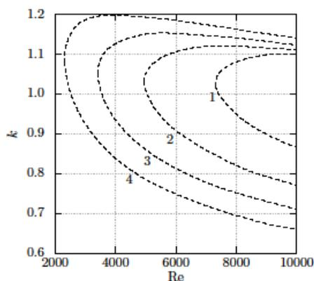
Рис. 3. Области неустойчивости течения термовязкой жидкости при фиксированном значении параметра  $\alpha_E = 1$  при  $m = 0.25$  (1),  $m = 0.5$  (2),  $m = 0.75$  (3),  $m = 1$  (4).
