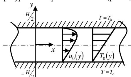
Рис. 1. Схема течения жидкости в канале.
