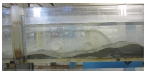
Рис. 5. Размыв песчаного дна - образование сквозной полости под двумя цилиндрами
