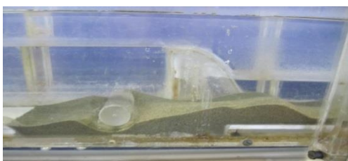
Рис. 4. Размыв песчаного дна - образование сквозной полости под цилиндром
