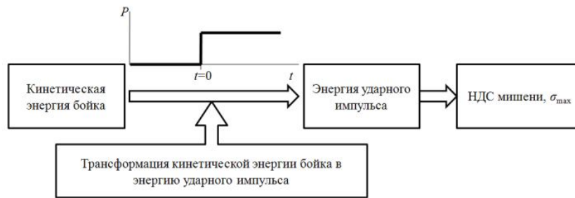
Рисунок 3 – Условия формирования напряженно-деформированного состояния (НДС) мишени в волновой модели продольного удара
