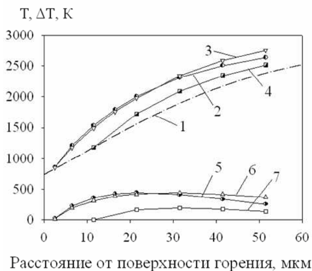
Рис. 5. Температурные профили в пламени гексогена, рассчитанные для двух термопар различной формы с близкой площадью поперечного сечения. 1 – T_{\text{RDХ}} ; 2 – Q(T) , 3 – Q(x) для T_{\text{ТП4}} ( 3 \times 60 мкм); 4 – Q(T) для T_{\text{ТП5}} ( 13 \times 14 мкм); 5-7 – \Delta T_{2,4} , соответственно.
